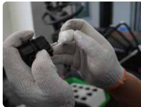
组装浮控式注液阀,并确认连接紧固
